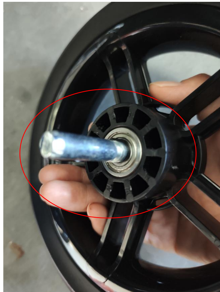
测试后轮子的状态(轮轴和齿块完好)
